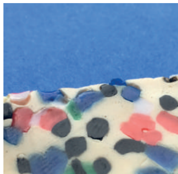
Recherches d'aspects proches du matériau appelé Terrazzo : argile blanche et bouchon plastique coloré chauffé au four.
