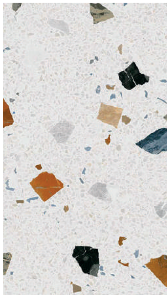
Terrazzo, fragments de pierre, et de marbre colorés agglomérés à du ciment.
