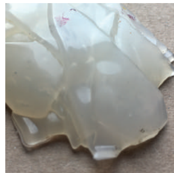
Plastique transparent n°5 d'un bidon de lessive fondu au four dans un moule en silicone.
