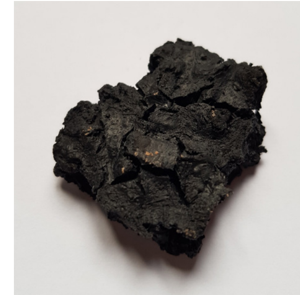
caséine nature + morceaux de charbon (séchage à l'air libre)
