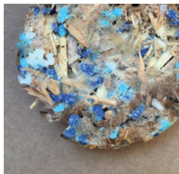
Mélange de bois, de bouchons plastiques et de colle à bois, chauffés au four.
