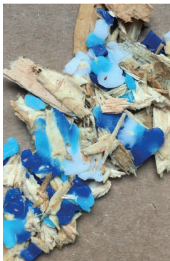
Le plastique colle et apporte une souplesse entre les copeaux. Assemblé avec un fer à repasser.
