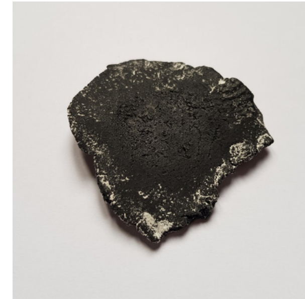
caséine nature + charbon (séchage à 1m50 d'un feu de bois)
