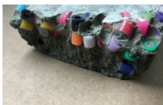
Béton et perles de plastique : très peu probant.
