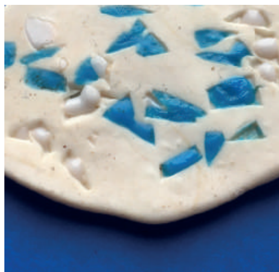
Recherches d'aspects proches du matériau appelé Terrazzo : argile blanche et bouchon plastique coloré chauffé au four.
