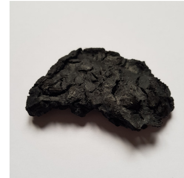
caséine nature + morceaux de charbon (séchage à l'air libre)
