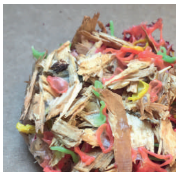
Mélange de bois, de morceaux de pailles fondus au four.
